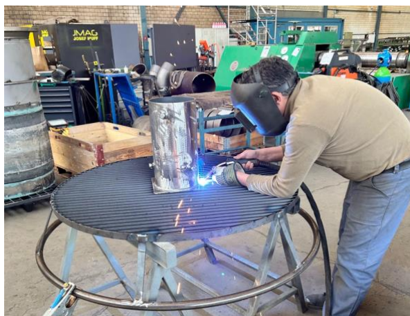
Rohr mit dem Gitter verbinden
